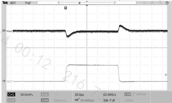
图 14 2.5V 输出瞬态响应
