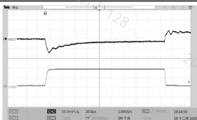
图 9. V_{OUT} = 5V , I_{load} = 100mA-2A 输出瞬态 AC 响应
