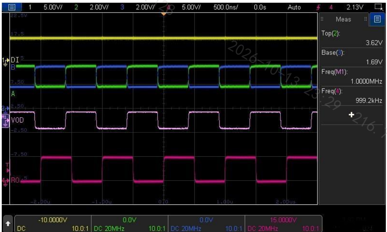
图 14 接收器模式的 2Mbps 波形 ( \overline{RE}=GND , DE=GND )
