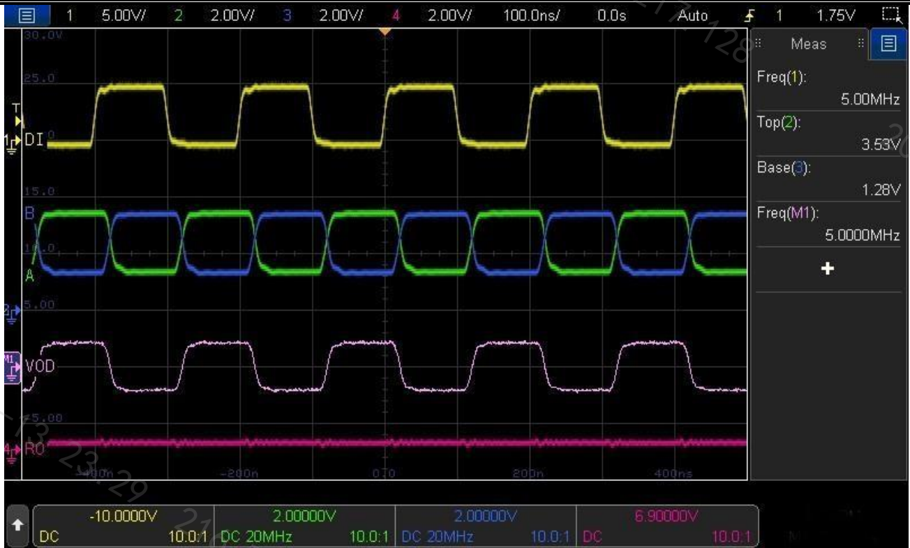
图 15 驱动模式的10Mbps波形 ( \overline{RE}=V_{CC} , DE=V_{CC} )
